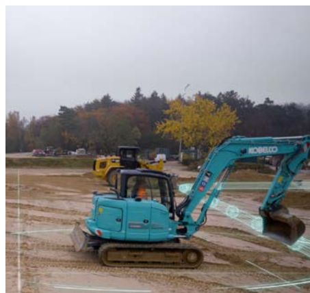
Als de graafmachine te dicht bij de hogedrukpijpleiding komt, gaat er een alarm af in de cabine.
